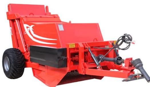
Камнеуборочный агрегат предназначен для сбора мелких камней при помощи оборудованного ротора с гребенкой, расположенной на фронтальной оси, оснащенной пружинами безопасности.
