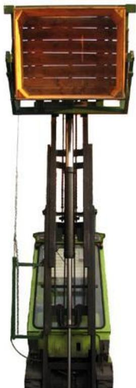
Используется для высыпания фруктов из ящиков стандартных размеров 100x120x80 см. Монтируется на любой тип погрузчика.
