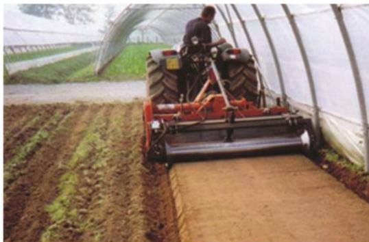
Фрезерные грядообразователи предназначены для качественной обработки почвы и формирования её в грядки, под засадку овощными культурами. Машина формирует плотные гребни, которые позволяют хорошо проникать влаге и сохранять ее. Гребнеобразователь состоит из фрезы, пластины и формирующего щита с колесами или гидравлических катков (опционально). Существует возможность установки независимой гидросистемы.
