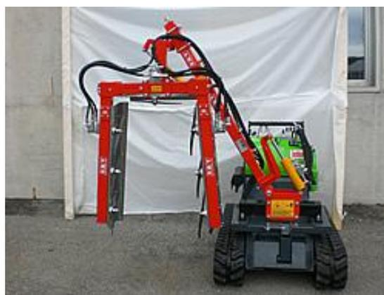
Все модели чеканочных агрегатов вешаются на переднюю навеску трактора. Закаленные стальные лезвия обеспечивают высокое качество обрезки. Четыре гидравлических движения, позволяют идеально адаптировать работу машины к вашему ряду.
